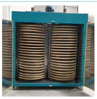
Double Racks Drying Machine Inside Двухслойная сушильная машина внутри
