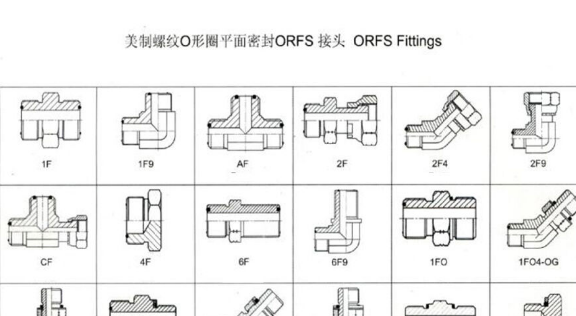
美制螺纹O形圈平面密封ORFS接头 ORFS Fittings
